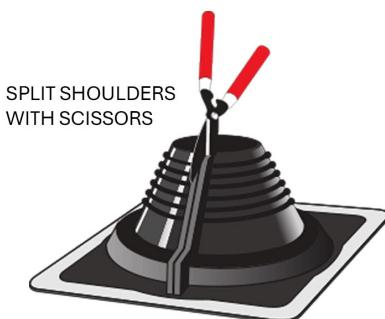
CRIMP FLASHING SHOULDER WITH RETROFIT CLIPS. FACE JOINT DOWNSTREAM.
