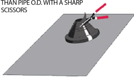
HALFWAY PEEL BACK THE LINING FROM THE UNDERSIDE OF THE AQUA TILE, SO THAT PIPE IS GIVEN ACCESS TO THE RUBBER BOOT
