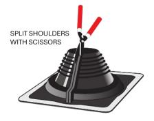
CRIMP FLASHING SHOULDERS WITH RETROFIT CLIPS. FACE JOINT DOWNSTREAM.
